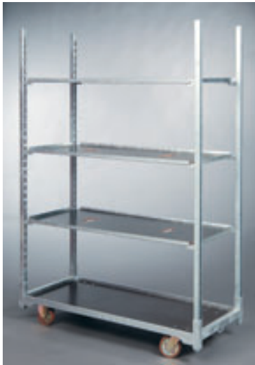
Art.-Nr. DC Container Grundboden + 3 Etagen L: 1350 mm B: 565 mm H: 1900 mm Bereifung: Ø 125 mm 2 Bockrollen, 2 Lenkrollen
